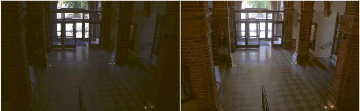
Figure 4. 用具有不同dB值的摄像机拍摄的背光内部场景。出乎意料，拍摄右图使用的摄像机的dB规格值小于左图所用的摄像机。
