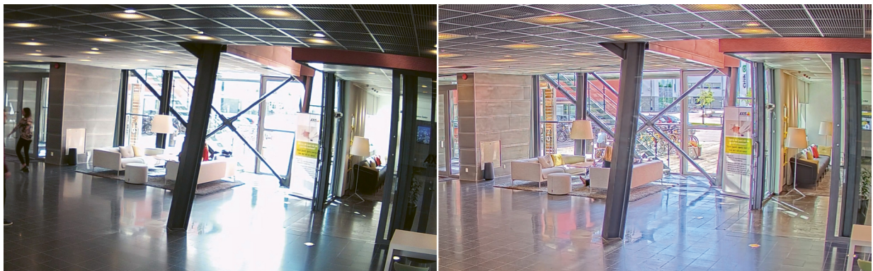
Figure 3. 强背光下的室内场景。不带宽动态功能的摄像机（左边）与安讯士Forensic WDR（猎影超宽动态技术）摄像机（右边）的对比。
