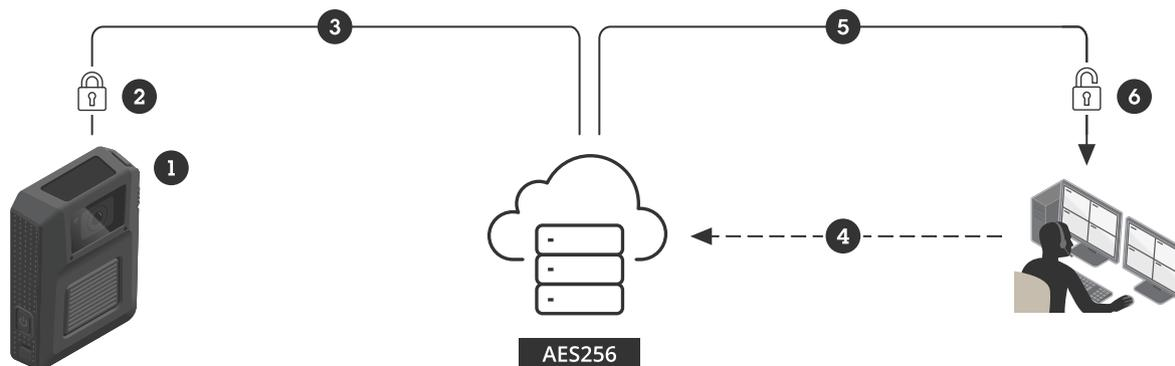
*Flux sécurisé en direct avec chiffrement de bout en bout dans AXIS Body Worn Live*
