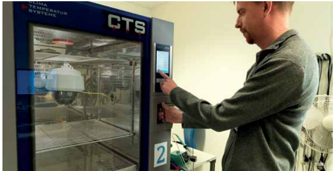
Figure 5 : Essai thermique dans une chambre climatique.
