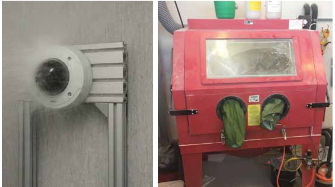
Figure 3 : À gauche : essai d'étanchéité d'une caméra ; à droite, chambre à poussière.
