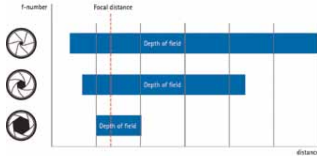
图2. 上图是不同尺寸光圈孔的景深（表示为景深值）示例。光圈孔越小，景深值越大，更长距离内的物体可同时聚焦。取决于传感器像素尺寸，过小的光圈孔可能导致图像模糊（衍射）。
