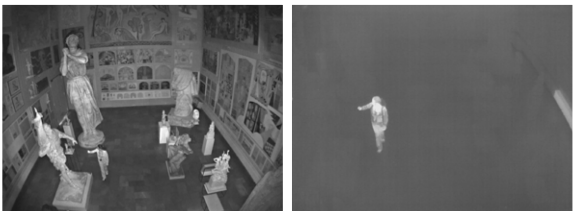
圖 4 和 5：左邊是配備整合 IR 照明的日夜兩用攝影機影像，而右邊是被動偵測熱輻射的熱顯像攝影機影像。
