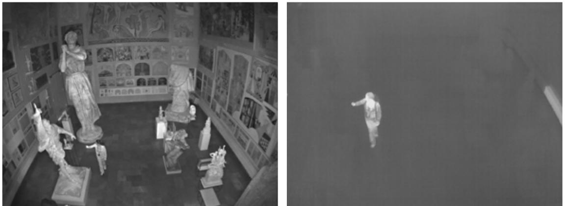
図4、図5: 左側は赤外線照明内蔵カメラによる画像、右側は熱放射を受動的に検出するサーマルカメラによる画像。
