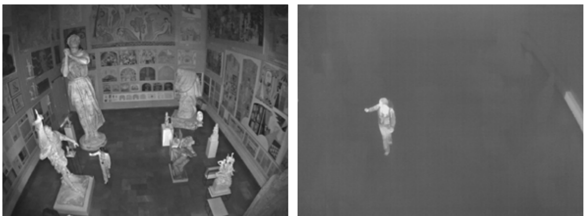
Figure 4 et 5 : à gauche, une image provenant d'une caméra jour/nuit avec éclairage IR intégré et à droite, une image provenant d'une caméra thermique, qui détecte passivement le rayonnement thermique.
