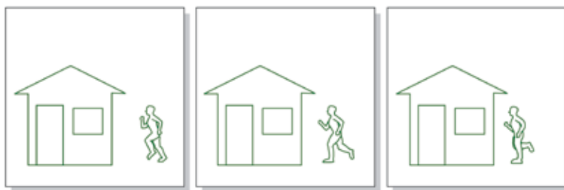
图3. 对M-JPEG格式来说，上述序列中的三个图像分别作为独立的图像（I帧）进行编码和发送，彼此之间互不依赖。
