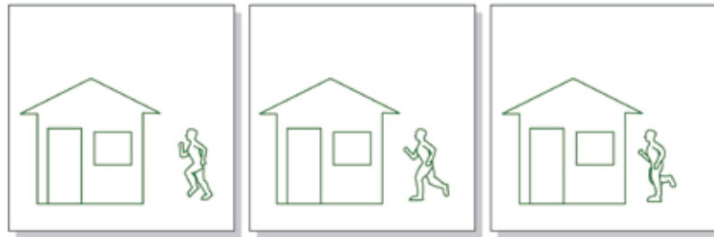
Figura 3. Com o formato Motion JPEG, as três imagens na seqüência acima são codificadas e enviadas como imagens únicas separadas (quadros I) sem dependências entre si.
