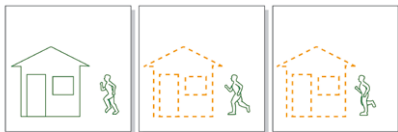
Figura 4. Com a codificação de diferença (usada na maioria dos padrões de compactação de vídeo, incluindo H.264), somente a primeira imagem (quadro I) é codificada em sua totalidade. Nas duas imagens a seguir (quadros P), são feitas referências à primeira imagem dos elementos estáticos, p. ex., a casa e somente as partes em movimento, ou seja, o homem correndo, são codificadas por meio de vetores de movimento, reduzindo assim a quantidade de informações enviadas e armazenadas.
