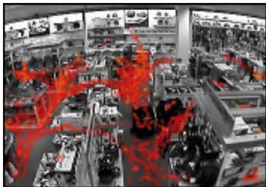
Изображения системы сетевого видеонаблюдения, которая регистрирует и отображает перемещения покупателей. Перемещение покупателей обозначено красными линиями. Изображение является собственностью компании IBM.
