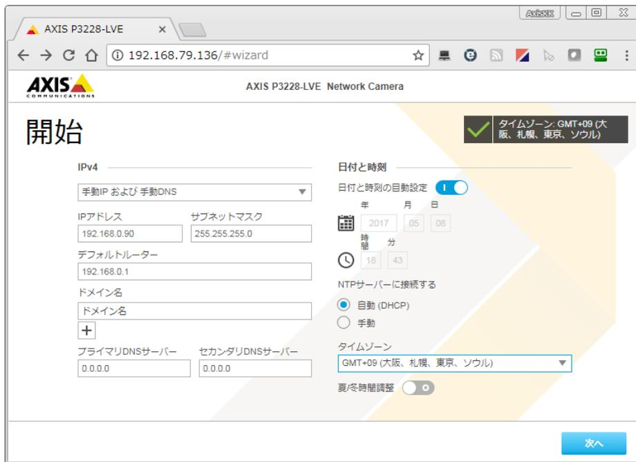
※注意：安定した NTP サーバーと時刻同期する設定を推奨します。特にエッジストレージ (SD カードおよび NAS) に録画する場合は製品の時刻情報が録画上の時刻となります。
