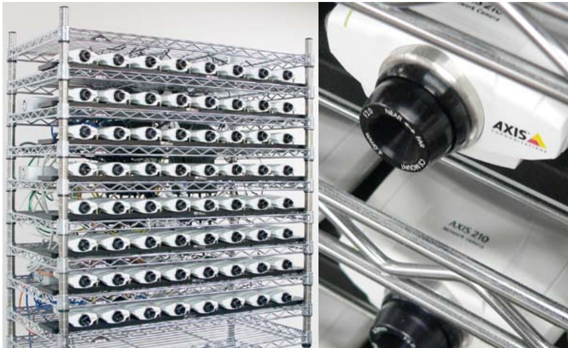
縦8台×横8台=64台で構成される「多眼カメラ」システム
