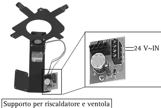
19. Collegare i cavi di alimentazione (non forniti) al connettore presente sul supporto del riscaldatore e della ventola.
