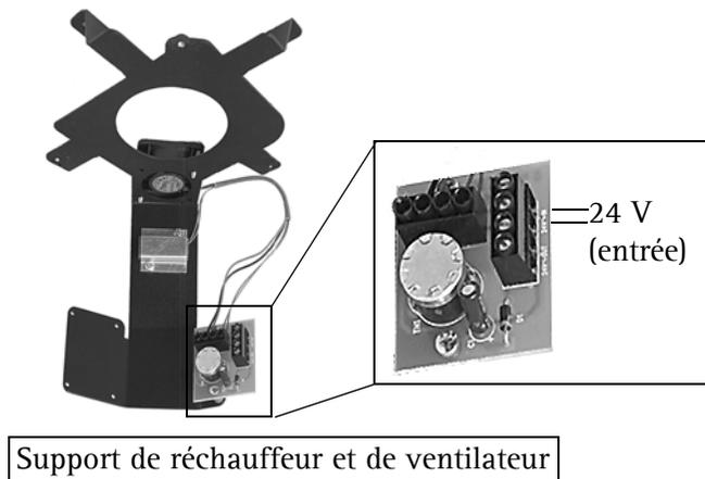
7. Branchez les câbles d'alimentation (non fournis) au connecteur sur le support du réchauffeur et du ventilateur.
