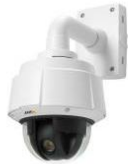
Sieciowa kamera kopułkowa AXIS Q6034-E PTZ, najwyższej klasy model do zastosowań zewnętrznych
